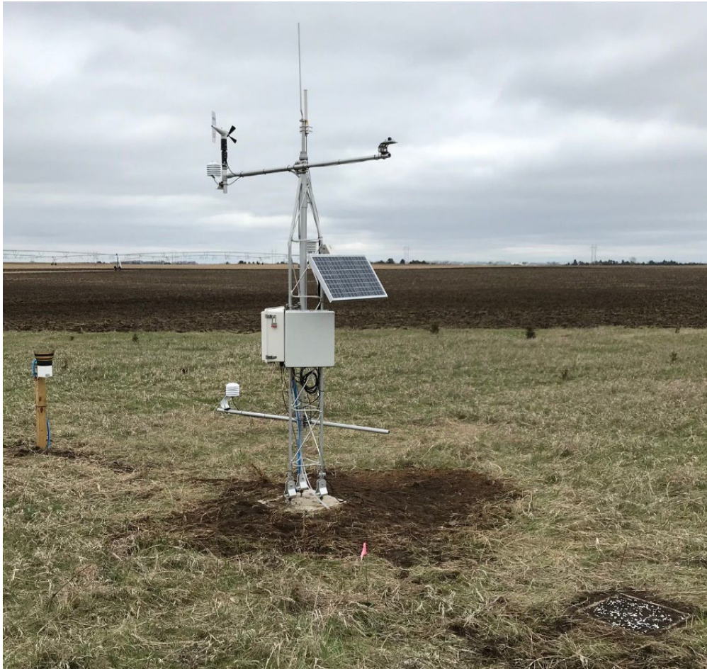
Figure 2.9 – Station météorologique, un dispositif qui se veut représentatif des techniques de monitoring atmosphérique moderne
