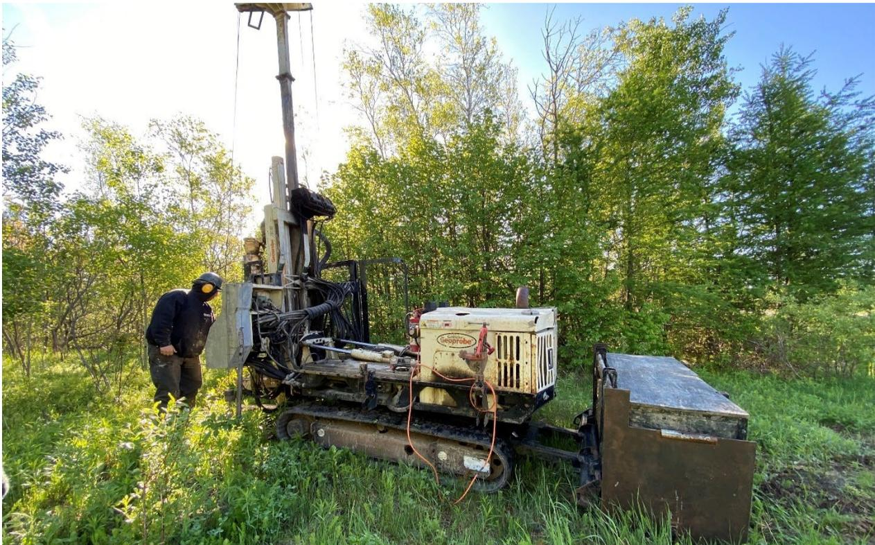
**Figure 1 : Foreuse Géoprobe 7822DT**
