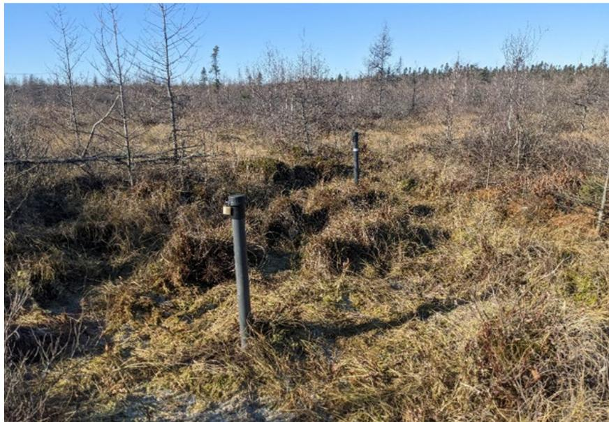
**Figure 3 : Piézomètres S1 et T1 dans la réserve écologique**
