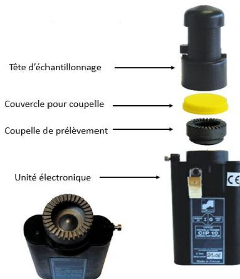
Figure 2.2 : Image des différentes parties mécaniques d'un CIP10-M (Arelco, 2003)
