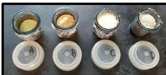
Figure 1.7 : Image des différents polyuréthanes broyés et utilisés dans le cadre de ce projet de recherche; PU A, PU B, PU C et PU D
