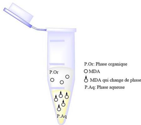
Figure 1.12 : Schéma du principe d'une extraction liquide-liquide où la phase organique est composée de toluène
