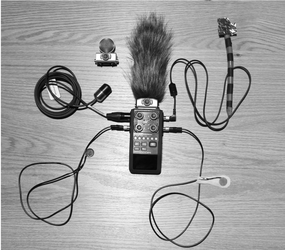
Figure 2.6 (2020). *Appareil d'enregistrement Zoom H6 et connectivité des différents micros* [Photo numérique].
