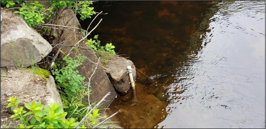
Figure 3.2: Exemple d'installation d'une sonde limnimétrique (station du bassin versant Sagouay)
