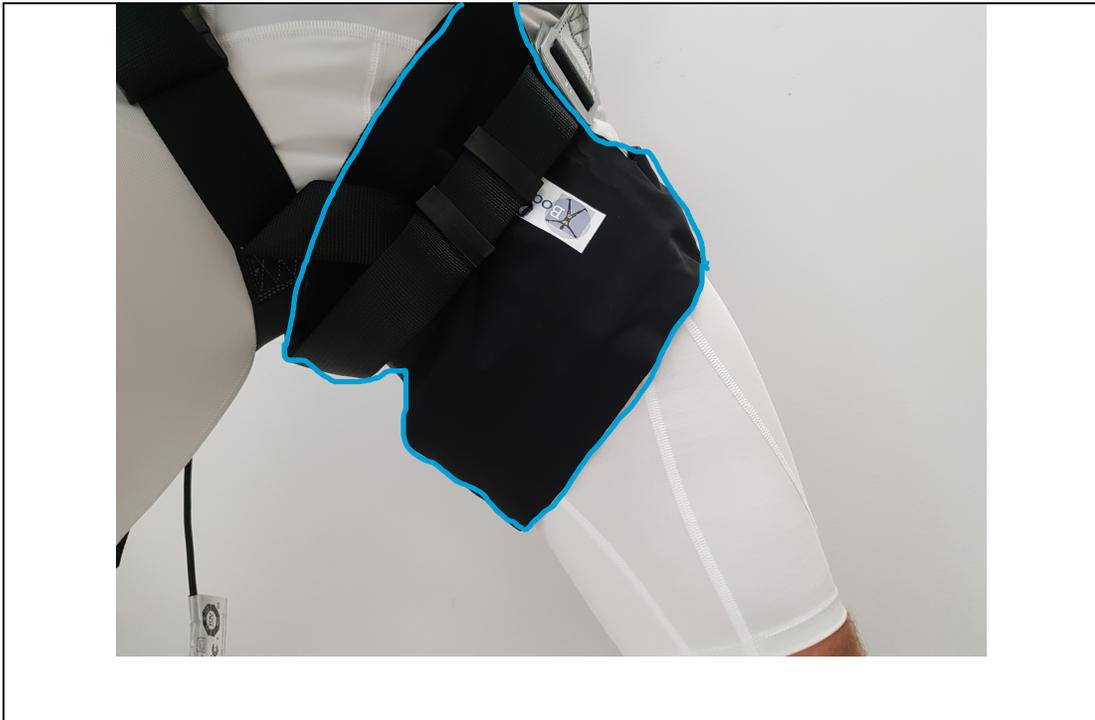
Figure 4. 10. Tapis de pression disposé au niveau de l'aine d'un participant.
