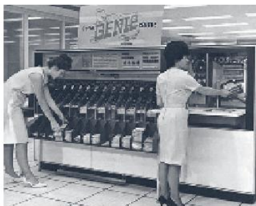
La machine IBM servant à trier les chèques au Centre de génie de Montréal, en 1963. Cette machine pouvait traiter jusqu'à 1 600 chèques à la minute.
