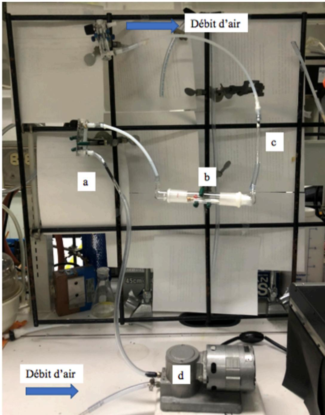
Figure 2.2 Dispositif d'aération contrôlée au laboratoire : (a) filtre de charbon actif; (b) diffuseur de phéromones ; (c) cartouche de charbon activé pour capter les volatiles ; (d) tuyau vers la pompe, en poussée.
