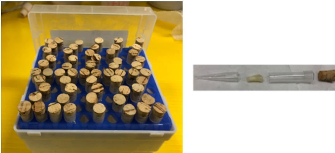
Figure 3.7 Boite de 60 diffuseurs de la phéromone sexuelle. Chaque diffuseur a été fabriqué à partir d'un embout de pipette en polypropylène de 1 mL contenant un filtre à cigarette en acétate de cellulose, ensuite fermé avec un bouchon en liège.
