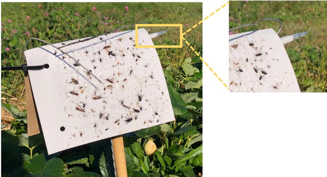
Figure 2.3 Piège collant, comportant un diffuseur de phéromone sexuelle synthétique, installé dans un champ de culture fraisière.
