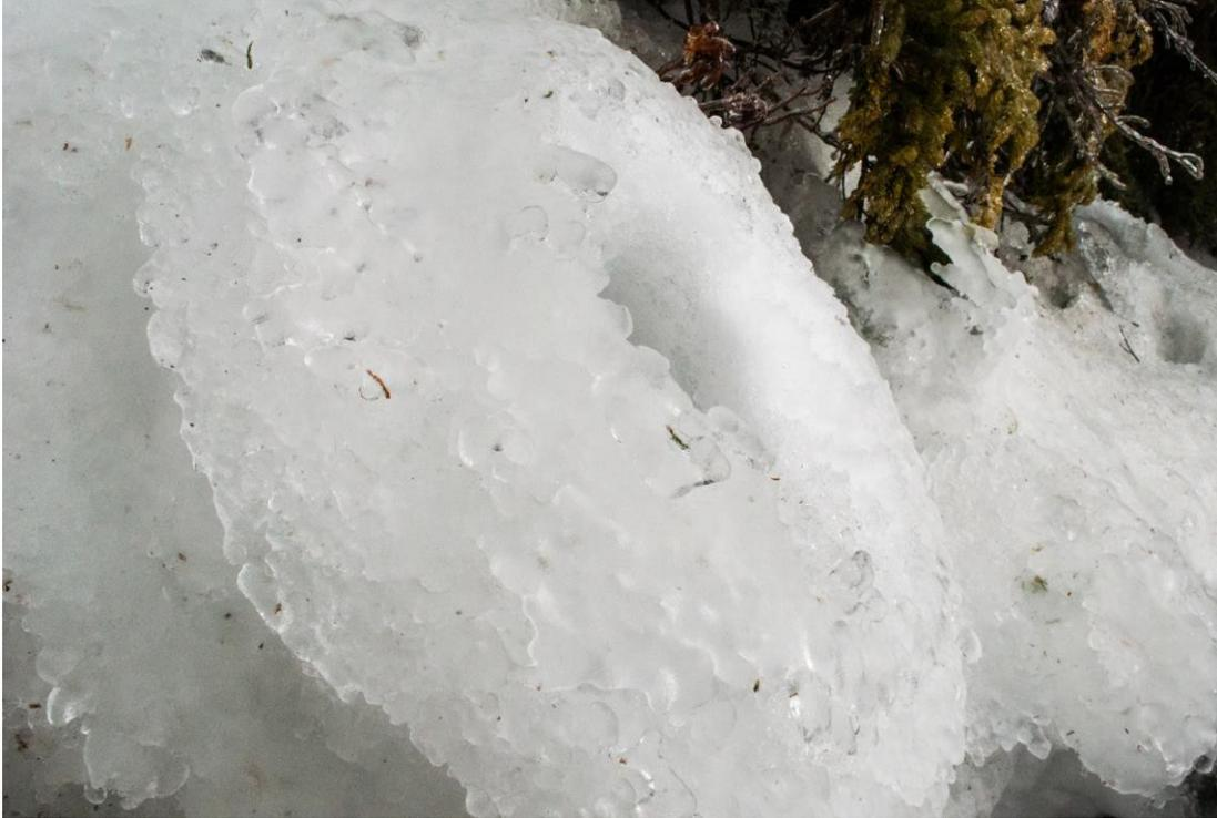
Figure 4.8 : Photographie d'un trou d'aération d'air chaud. L'air chaud et humide de l'intérieur du talus gel au contact de l'air froid extérieur formant un beigne de givre d'environ 10 cm de diamètre.
