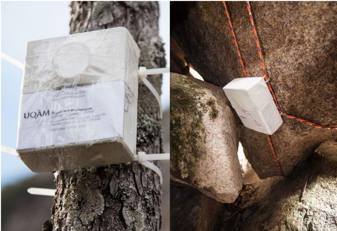
Figure 3.4 : Socle en bois permettant de protéger le i-button durant la récolte de donnée. À droite on observe une installation intérieure et à gauche une installation extérieure.
