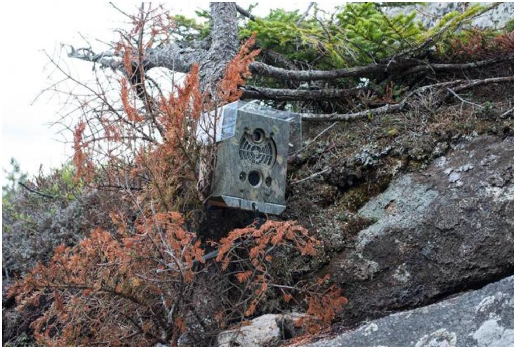
Figure 3.2 : Caméra time-lapse Spypoint HD10 avec une résolution de 10 mégapixels.
