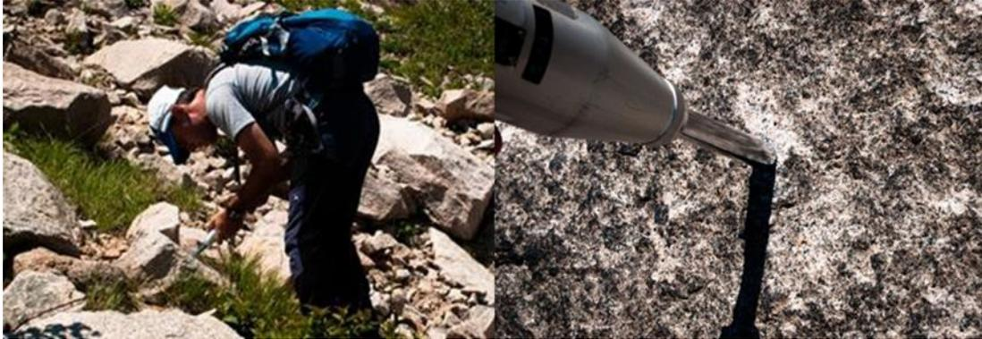
Figure 3.7 : Utilisation du marteau de Schmidt sur les roches situées à l'intérieur du site d'étude.
