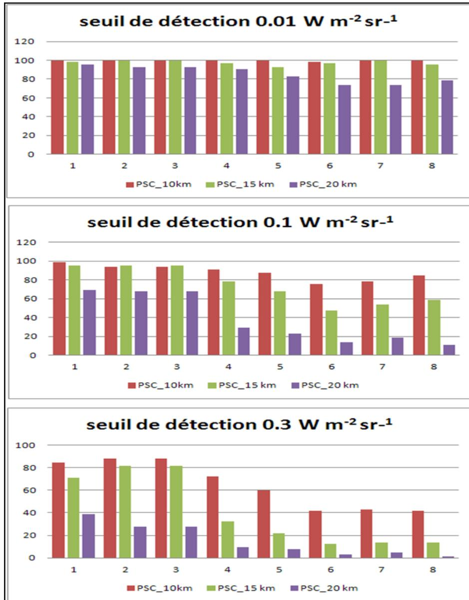
Figure 4.36 Représentation du taux de détection des nuages à chaque altitude en fonction du seuil de détection pour les 8 bandes de TICFIRE. Les Altitudes des PSC indiquent la base du nuage dont l'épaisseur peut atteindre 600 m dans le cas des PSC à 10 km et 100 m dans le cas des PSC 20 km.
