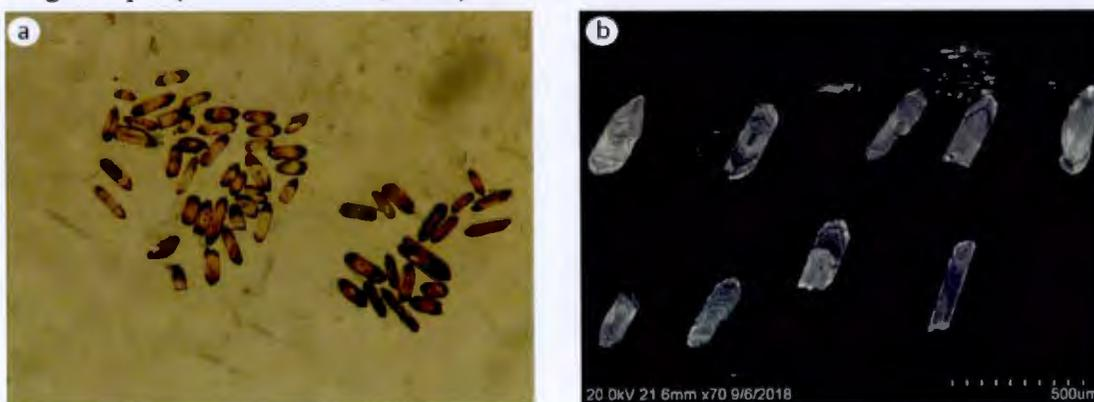
Figure 6.9 - a) Deux populations de zircons de l'échantillon 16-NR-3786 observées au microscope binoculaire. b) Illustration des textures de zonation oscillatoire et surcroissances en cathodoluminescence.
