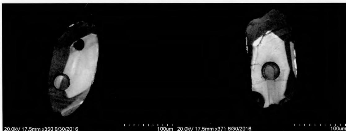
Figure 2.7 - Images de zircons en cathodoluminescence (CL). Les deux minéraux présentent une zonation en secteurs avec un cœur clair et une bordure plus sombre en CL. Sur l'image de gauche le puits d'ablation du laser empiète sur les deux zones de croissance et livrera un âge mélangé discordant. Sur l'image de droite, le puits d'ablation est au centre de la zone claire en CL et devrait livrer un âge représentatif de ce domaine dans le zircon.
