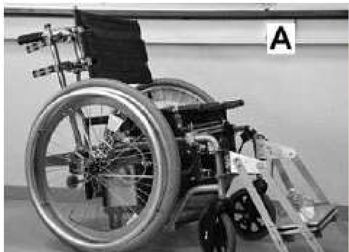
Figure 1.18 Fauteuil roulant ergomètre autonome (FRET-1) (Sauret et al., 2014) (reproduit avec autorisation de Taylor & Francis © )
