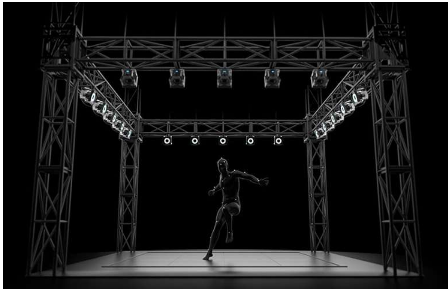
Figure 1.2 Représentation d'un système de capture du mouvement et d'un sujet (Optitrack, 2019)
