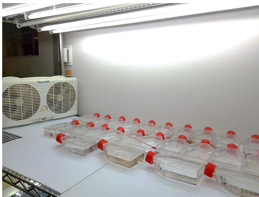
Fig 3.2 : Exposition de la plante L. minor aux différents traitements du \text{CdCl}_2 et/ou d'oxyde de graphène pendant sept jours.
