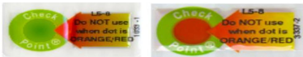
Figure 37 - Fonctionnement du TTI Enzymatique : L'hydrolyse du triglycéride provoque la libération d'acides carboxyliques et la chute de pH induit le changement de couleur d'un indicateur du vert foncé au rouge orange.
