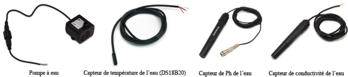
Figure 10 - Matériel électrique et électronique (capteurs dans le baril d'eau) de Sonoponie
