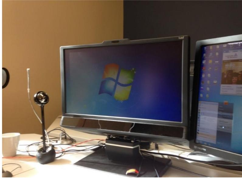
Figure 12 : Photo du moniteur avec l'oculomètre TobiiEyeX® TX300
