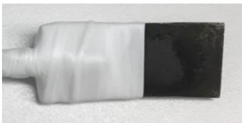
Figure 2.7. Électrode typique préparée pour les mesures électrochimiques et photoélectrocatalytiques.
