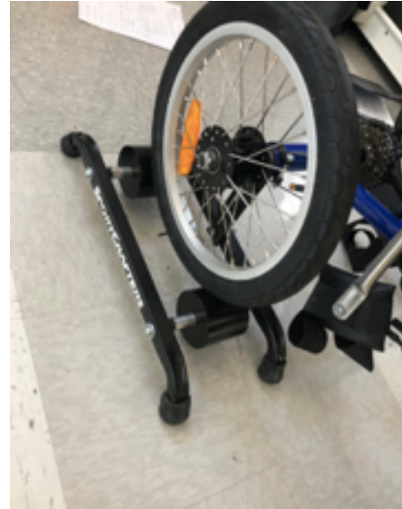
Figure 3.4 Roue mobile du tricycle fixée sur rouleau
