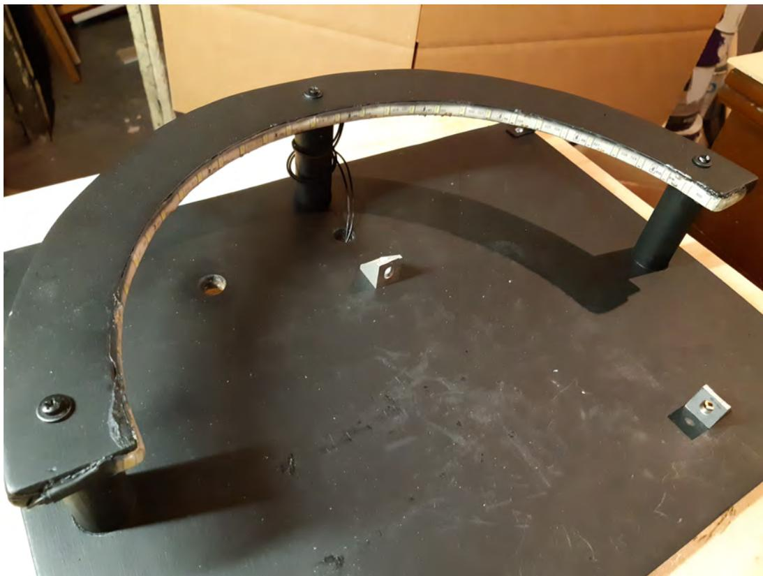
*Figure 4.12. Bande de DEL servant à éclairer la caméra-robot*
