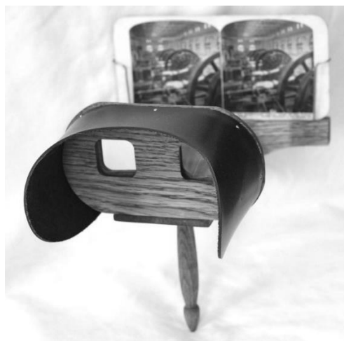
Figure A17 : Exemple de dispositif optique stéréoscopique (stéréoscope de Holmes entre 1850 et 1900)
