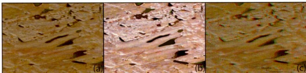
Figure 3.5 Divers types d'images *RapidEye* à une échelle topographique de 1:30 000. (a) image non traitée; (b) image traitée pour un rehaussement de couleurs; (c) traitements permettant la création d'images anaglyphes en 3D.
