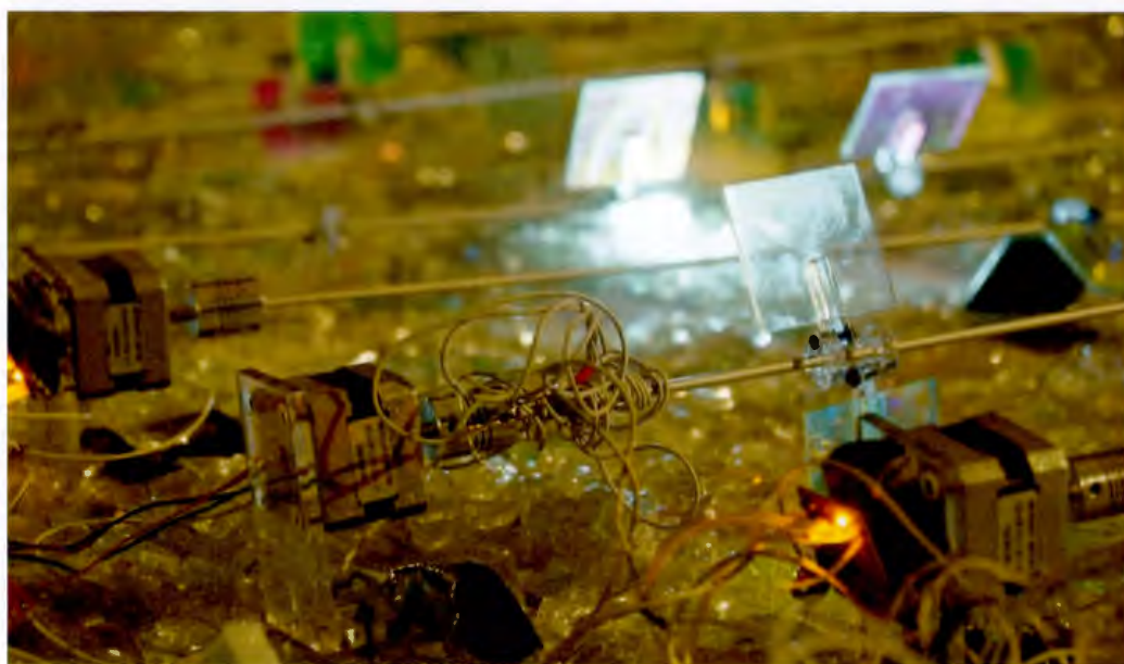
Figure A.19 Entortillement des fils électriques interférant avec le mécanisme précaire.
