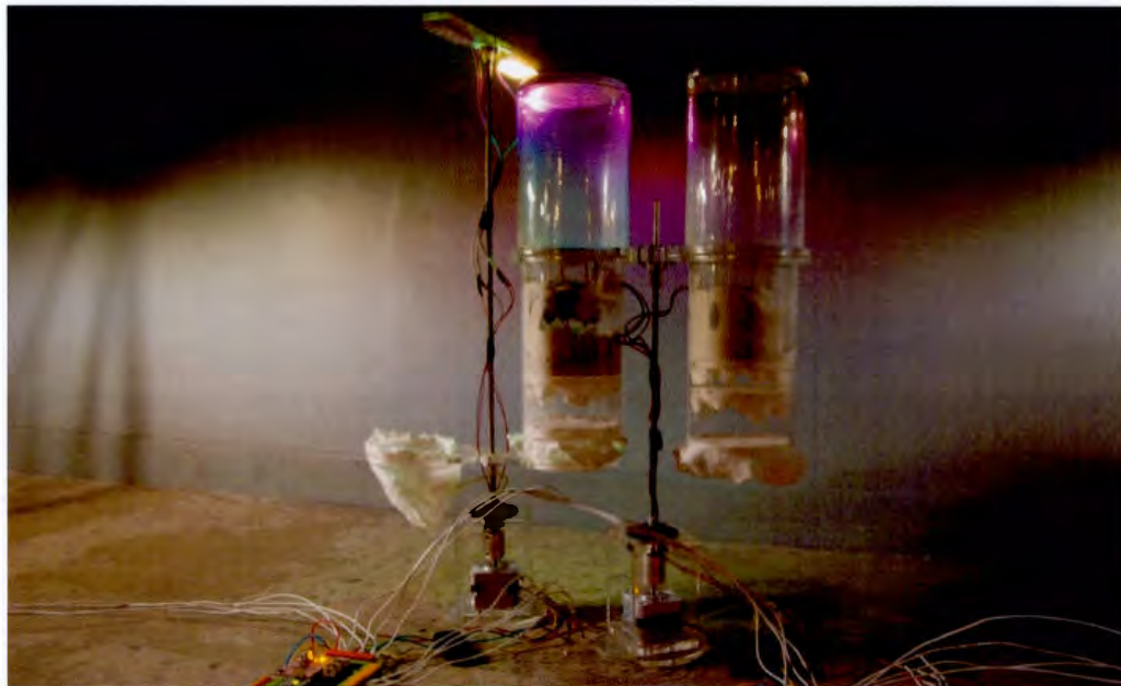
Figure B.14 Détail des couches de feutre. La poussière est expulsée dans des contenants plus petits et filtrée à travers une superposition de couches la laissant sédimenter.
