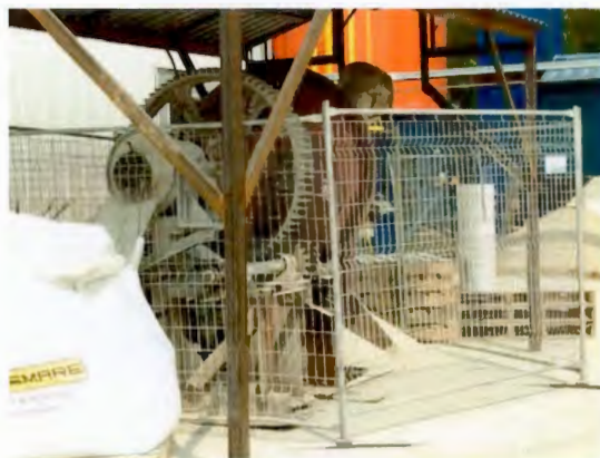
Figure 2.23 Le concasseur maison du Groupe Bellemare qui produit de la poudre pour le béton. Groupe Bellemare, Trois-Rivières, 2018.
