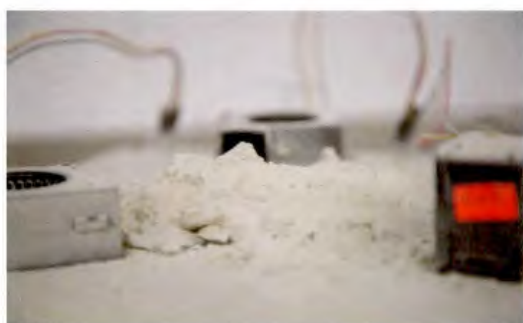
Figure 2.18 Certains prototypes ne permettaient pas de faire tourbillonner la poussière et ont impliqué plusieurs essais avec des ventilateurs de puissance variable.
