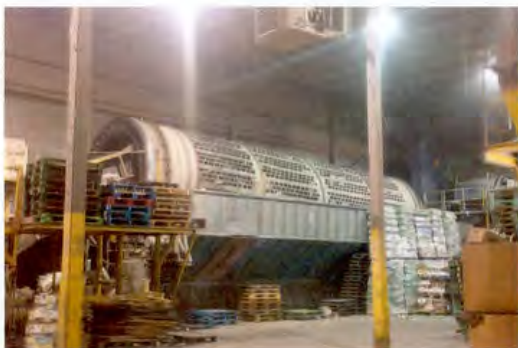
Figure 2.1 Le trommel servant à concasser le verre récupéré. 2M Ressources, Saint-Jean-sur-Richelieu, 2016.
