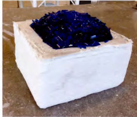
Figure 2.8 Moulage du verre recyclé en vue de la refonte. UQAM, Montréal, 2017.
