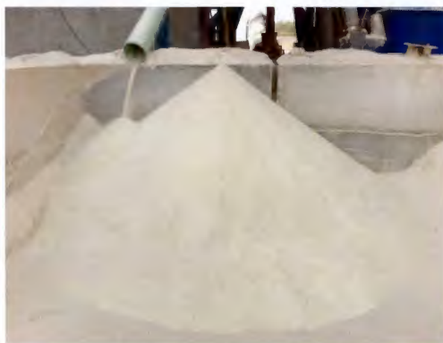
Figure 2.27 Poussière résiduelle captée par un dépoussiéreur puis s'accumulant proche du trommel. Groupe Bellemare, Trois-Rivières, 2018.
