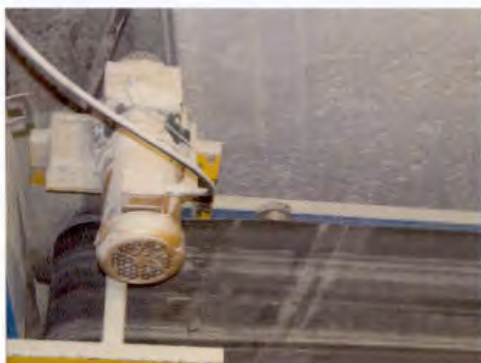
Figure 2.25 Sédiments de poussière s'accumulant sur les convoyeurs à l'intérieur du centre de recyclage 2M Ressources. Saint-Jean-sur-Richelieu, 2016.
