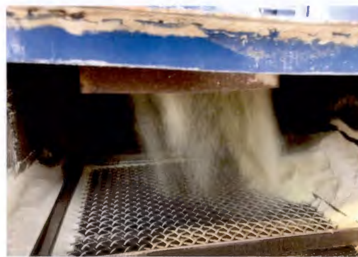
Figure 2.26 Particules fines expulsées du trommel et capturées par le système de dépoussiérage du Groupe Bellemare. Trois-Rivières, 2018.
