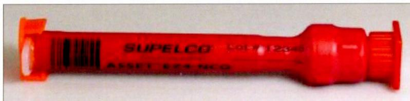
**Figure 1.5** Système d'échantillonnage dénuder/filtre (ASSET™ EZ4-NCO)
