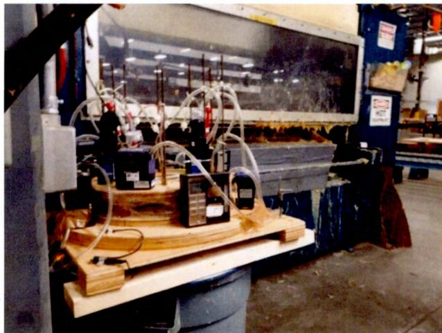
**Figure 1.14** Dispositifs de prélèvement placés près de la machine d'application de la colle chaude à base de MDI
