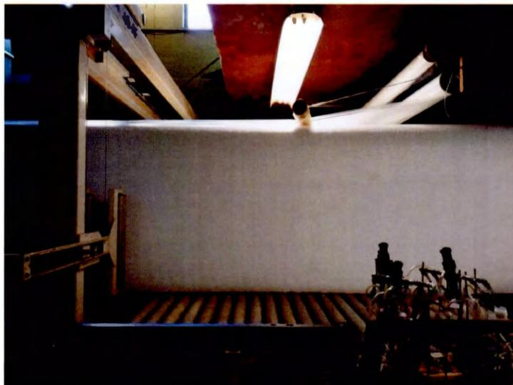
**Figure 3.1** Échantillonneurs placés au voisinage d'une scie à ruban pour la coupe de la mousse à base de TDI
