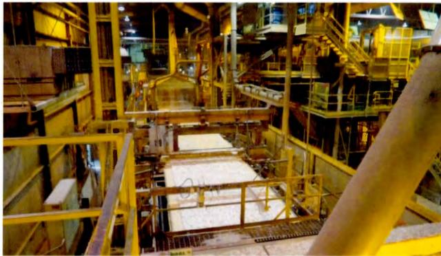
**Figure 1.12** Systèmes d'échantillonnage de MDI placés près de la ligne de formation (OSB-forming line)
