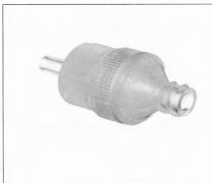
**Figure 1.10** Cassette de prélèvement pour la méthode de DAN
