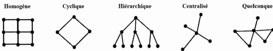
Figure 2-8 – Exemple des différents types de graphes
