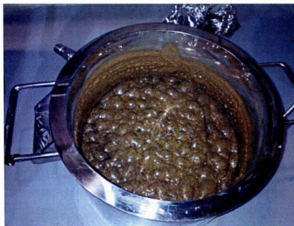
Figure 3.16 Mélange pour la fabrication de l'électrode composite : dégagement d'hydrogène et oxydation du silicium.
