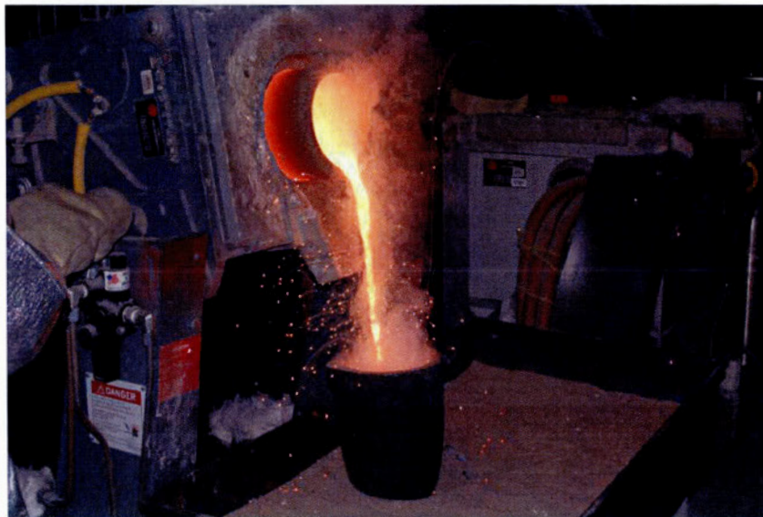
Figure 2.15 Fusion du silicium dans un four à induction de 200 kW équipé d'un creuset de graphite
