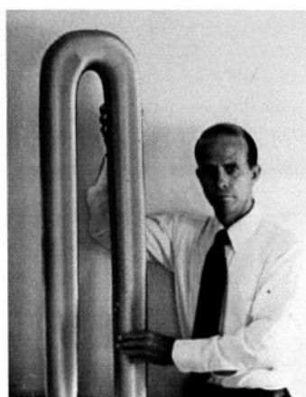
Figure 2.12 Réacteur Siemens pour déposition de silicium par CVD [32] et dépôt de silicium 9N
