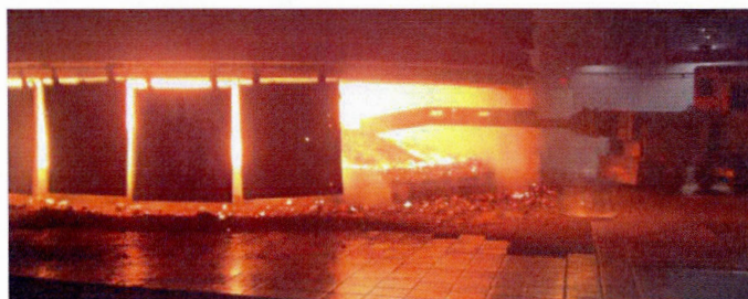
Figure 2.8 Ajout de matières premières dans le four à arc [28]
