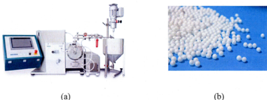
Figure 3.7 Équipement de broyage utilisés pour le broyage par voie humide du silicium : (a) broyeur-agitateur à billes (LabStar1, Netzsch) et (b) billes de broyage (Zirmil Y, St-Gobain)
