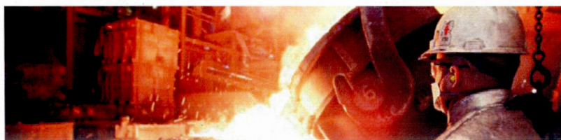
Figure 2.10 Coulée du silicium liquide dans des moules de fonte [28]
