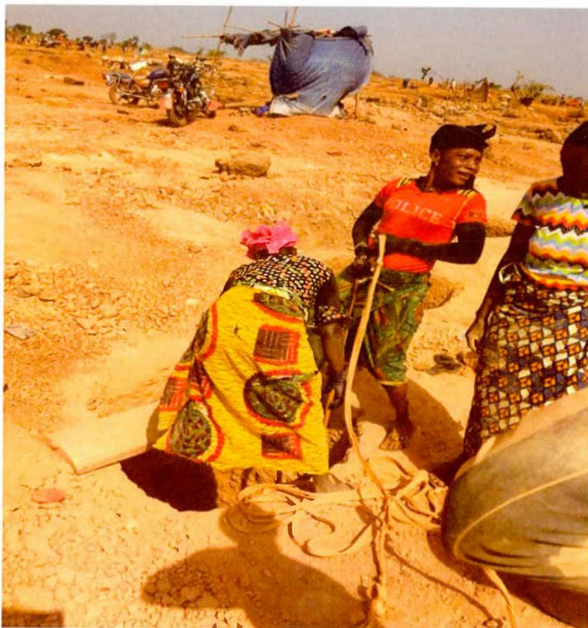
Figure 3. 14 Les orpailleuses en train de procéder à la remontée du minerai
