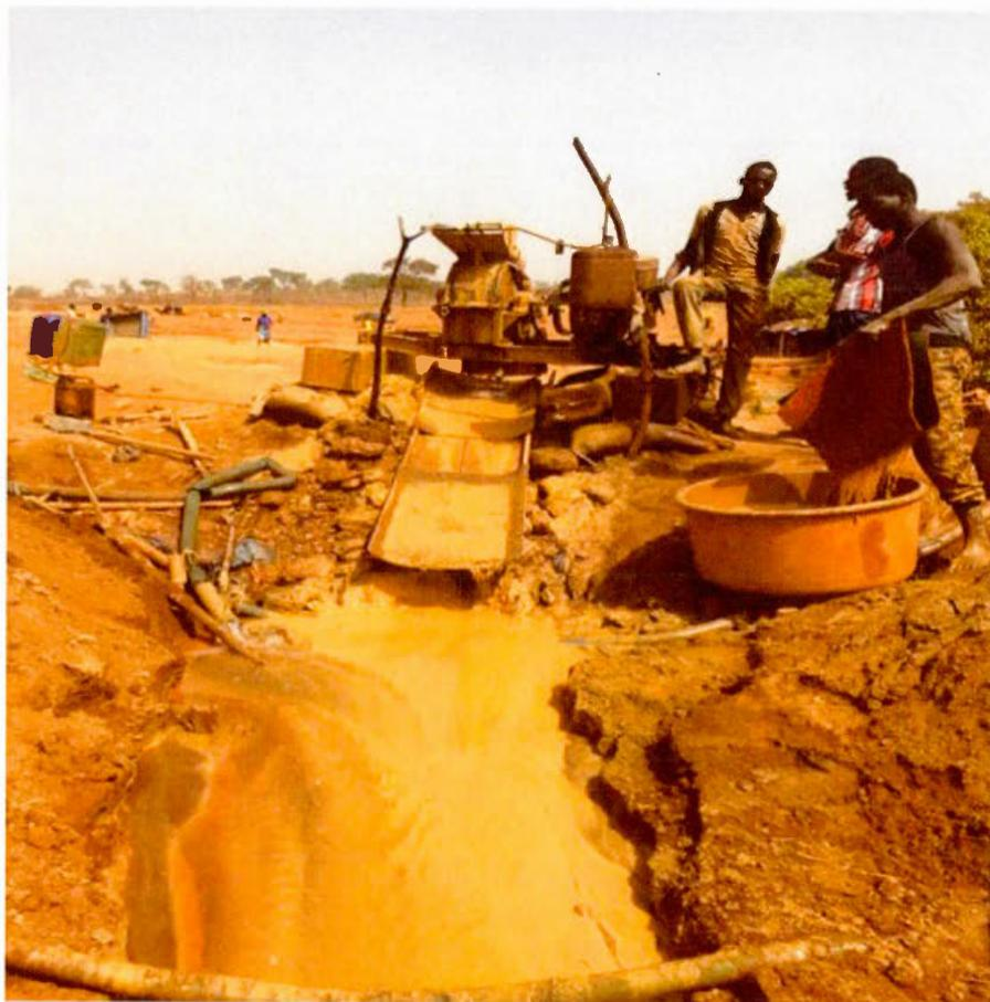
Figure 3. 20 Le broyage et le lavage des minerais de façon simultanée
