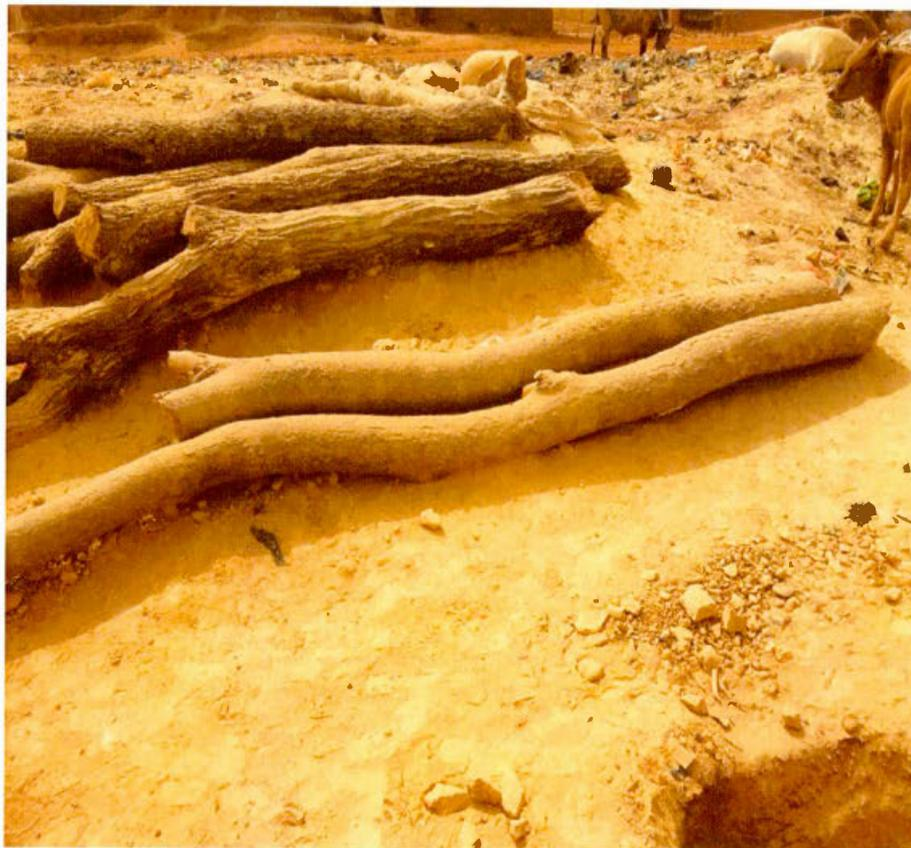
Figure 4. 5 Les bois destinés à améliorer les puits de grande profondeur
