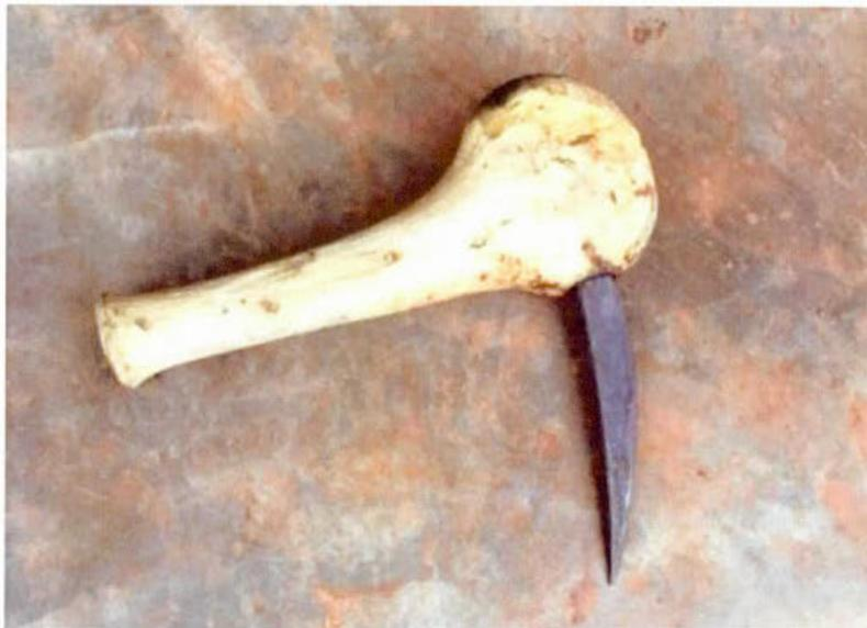
Figure 3. 5 La pioche creuseuse utilisée par les creuseurs
