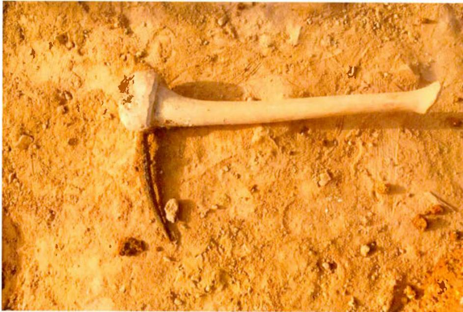
Figure 3. 8 La pioche coupeuse utilisée par les “Kaladjanti” pour couper le minerai
