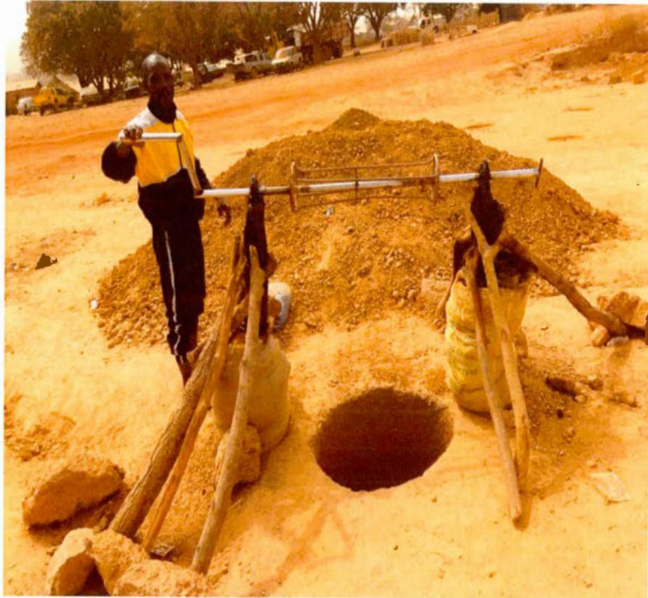
Figure 3. 15 Une autre technique pour remonter le minerai
