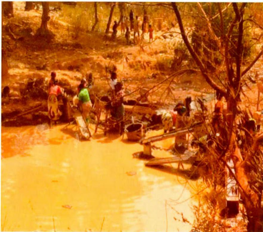
Figure 4. 3 Lavage du minerai dans un cours d'eau de Safounakoni à Kofilani
