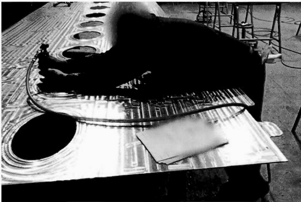
Figure 5.1 Travailleur effectuant l'ébavurage d'une grande pièce de métal suivant son usinage
