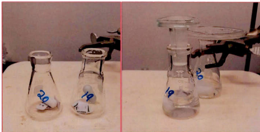
Figure 4.3 - Première étape du protocole d'extraction. À gauche : morceaux de carte après la pesée. À droite : début de l'agitation après ajout de DCM.
