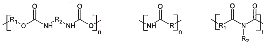
Figure 5.3 – Structure générale des polyuréthanes (gauche), polyamides (centre) et polyimides (droite). R = groupements alkyles ou aromatiques.
