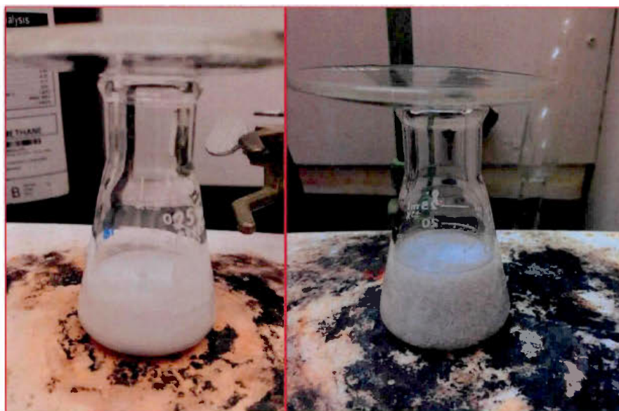
Figure 4.4 - Bout de carte dispersée dans le DCM. À gauche, carte en PC et à droite, carte composée d'un mélange de polymères.
