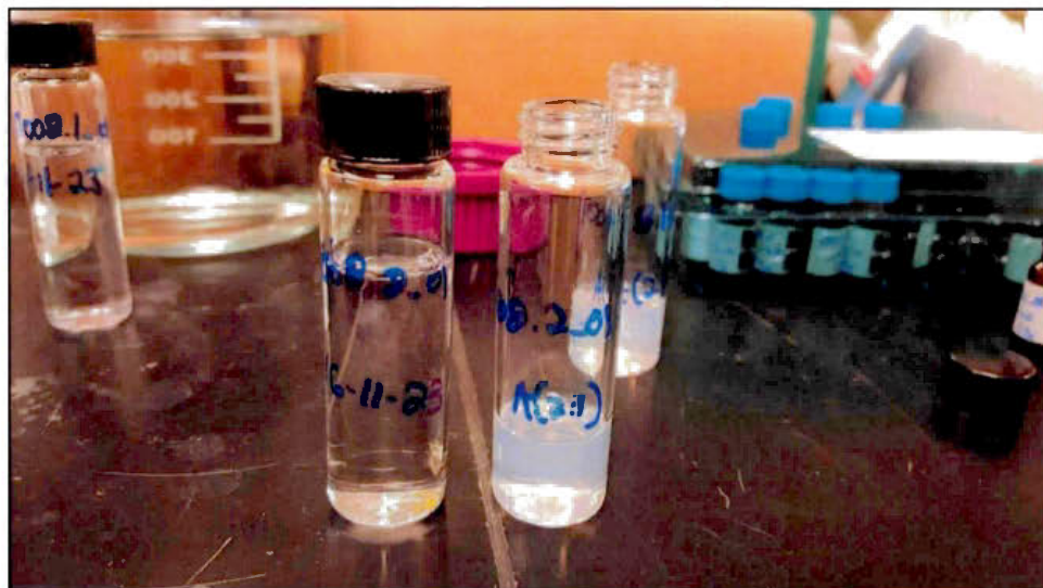
Figure 5.12 – Test de précipitation d'un extrait provenant d'une carte en polycarbonate. À gauche, l'extrait original et à droite, un petit volume de l'extrait précipité dans la phase mobile aqueuse (2 dans 1).
