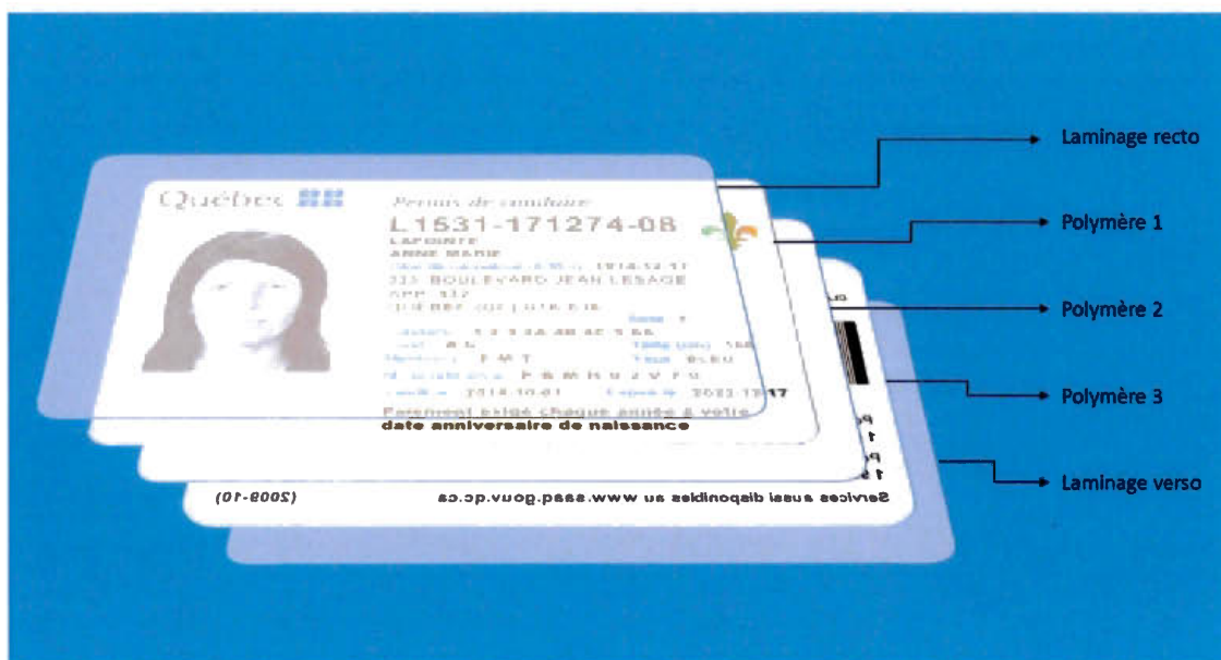
Figure 1.7 - Illustration de différentes couches employées dans la fabrication de cartes plastiques. (image inspirée de Schueller, 2017)
